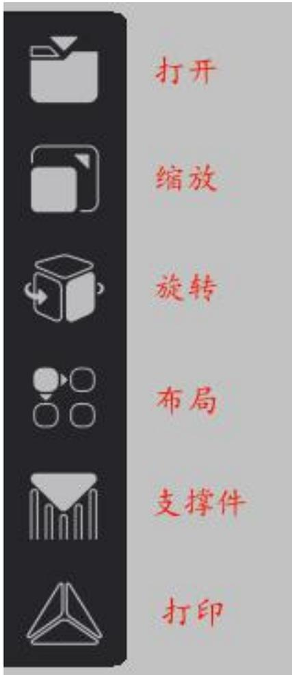
功能区从上到下一共六个按钮，“打开”对应菜单栏中“文件”菜单下的“打开”功能，“缩放”、“旋转”、“布局”、“支撑件”分别对应“编辑”菜单中的“缩放”、“旋转”、“布局”、“支撑件”功能。最后一个“打印”是启动打印按钮，连接打印机后才可激活。点击后会有三种打印精度可选，普通精度、高精度、超高精度，分别对应  $0.1\text{mm}$ / $0.05\text{mm}$ / $0.025\text{mm}$  的打印层厚。
