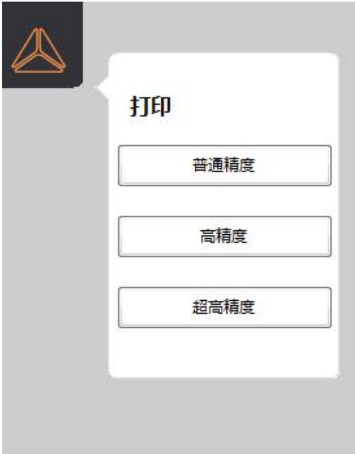
点击“普通精度”、“高精度”、“超高精度”中的任意一个，都会弹出耗材窗体，耗材选择根据耗材盒中的耗材。在弹出的窗口中选择打印材料的颜色和版本，一种打印材料对应一种打印参数，若软件中选择的打印材料与实际使用的打印材料不一致，将会影响打印效果甚至造成打印失败。为了防止用户误选材料，软件中模型的渲染颜色会随着所选材料的变化而变化。
